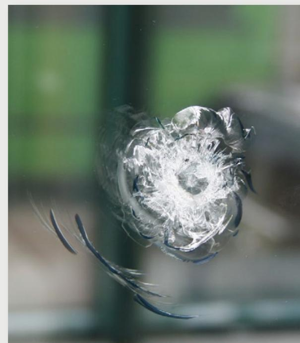
**Le verre de sécurité est spécialement conçu pour être plus résistant et durable que le verre standard. Il possède des propriétés qui réduisent les risques de blessures en cas de rupture du verre et compliquent les tentatives d'effraction. Ainsi, il garantit d'une part la sécurité des individus et d'autre part la sécurité des bâtiments, du matériel ou des biens.**
