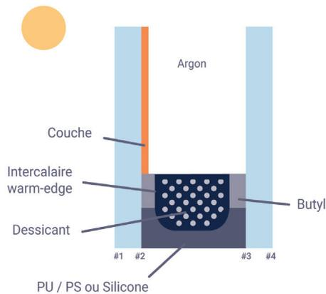
En double vitrage (6\*/15/4), ce vitrage arrête 72% de l'énergie solaire, tout en laissant passer 52% de lumière. Il est très neutre en transmission et a un aspect légèrement bleuté en réflexion. Ce vitrage permet de faire des économies d'énergie tant en période de grand ensoleillement qu'en hiver.
